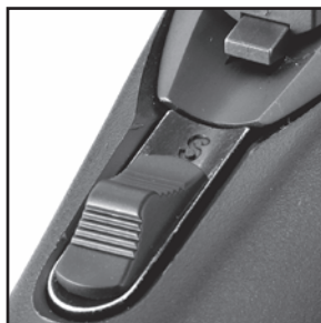
Obr. 6 Posunutím pojistky dozadu je pojistka v poloze "SAFE" neboli "zajištěno". Pokud je pojistka v této pozici, je možné volně manipulovat s pákou závěru. Pro běžnou manipulaci se zbraní mějte zbraň pořád zajištěnou.
