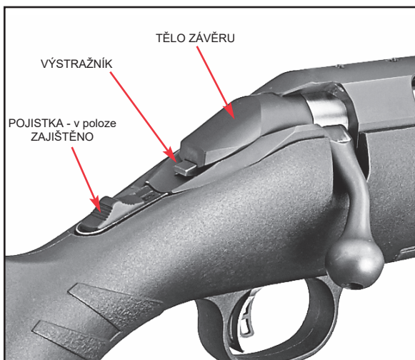
Obr. 2 Při natažení úderníku je jasně patrný výstražník ve spodní části těla závěru. Pojistka by měla být vždy v poloze "ZAJIŠTĚNO" pokud vyjímáte nebo vkládáte závěr zpátky do zbraně.
