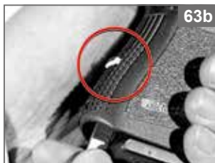
Indikátor na zadní straně rámu pistole ukazuje, že je pistole „zablokovaná“.
