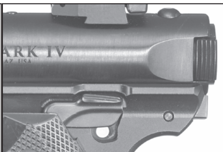
Obr. 6. Pojistka v poloze "zajištěno". Pojistka je v horní pozici a bílá tečka je jasně viditelná.
