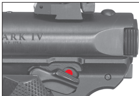
Obr. 5. Pojistka v poloze "odjištěno" / zbraň "připravena ke střelbě". Pojistka je v dolní pozici a červená tečka je jasně viditelná.
