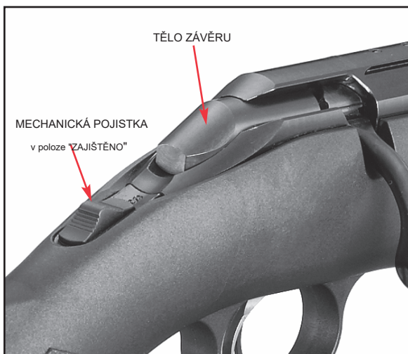
Obr 2. Pojistka by měla být vždy v poloze "ZAJIŠTĚNO" pokud vyjímáte nebo vkládáte závěr zpátky do zbraně.
