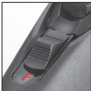
Obr 4. Zatlačením pojistky dopředu je pojistka v poloze “ FIRE ” neboli “ odjištěno ”. Pojistka by měla být posunuta do odjištěné polohy pouze tehdy, pokud je střelec připraven ke střelbě.
